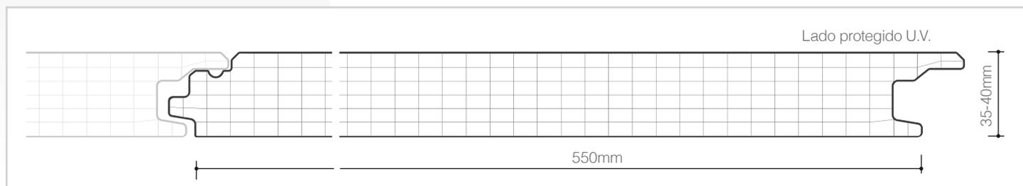
Sistema modular de policarbonato celular protegido U.V. para paramentos verticales y encajar con paneles sandwich de fachadas sin remates de acople
