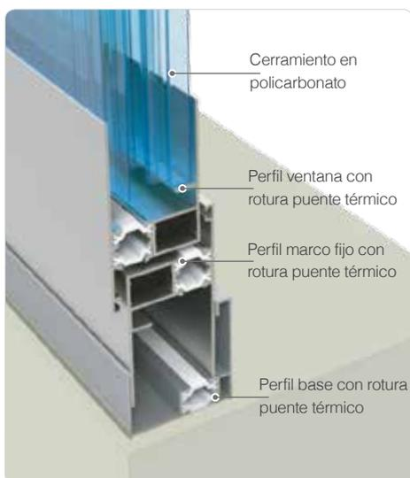
Para una correcta instalación está previsto el cierre de las celdillas de los paneles de policarbonato con las correspondientes cintas adhesivas de aluminio microperforado, que permiten la ventilación interior de las celdillas de los paneles y evitan que se ensucie el interior.
