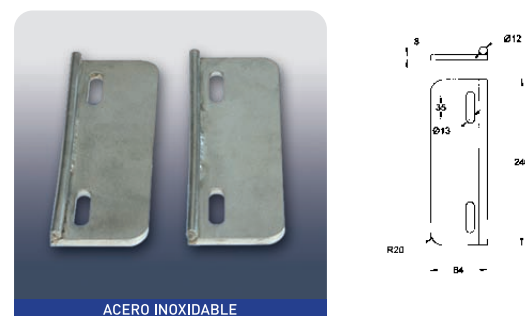
P-21 Placa fijación por pestañas inox 8 mm ( 2 unidades)
