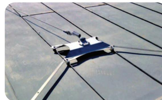
En algunos casos es necesario reforzar los anclajes finales o esquinas de las líneas de vida con brazos de refuerzo. Estos brazos reparten mejor la fuerza de caída en una superficie más grande de cubierta. Es necesario indicar la separación entre juntas de la cubierta para la elección correcta de la longitud de los brazos.
