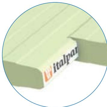
Panel de fachada con núcleo de poliuretano de fijación vista cuya instalación se puede ejecutar tanto vertical como horizontal. Aplicable a todos los sectores. La particular geometría del encaje permite un cierre muy fuerte y una perfecta estanqueidad. Está disponible en varios materiales, colores y acabados estéticos en ambas caras del panel.
